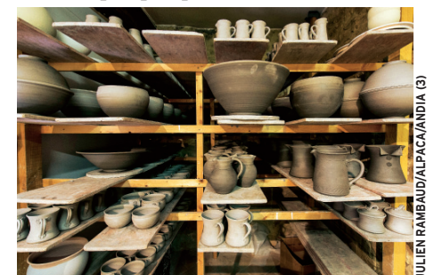
Le grès nécessite des températures de cuisson élevées mais offre une grande résistance.
